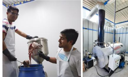
en los procesos, y considera un área total de 105 m<sup>2</sup>. La implementación de equipamiento ha constado de los siguientes bienes: una caldera para generación de vapor, dos reactores de acero inoxidable con doble chaqueta, una trituradora industrial y un cuarto de frío con paneles de poliuretano.
